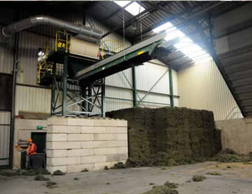
In deze hal komen de voorbereikte vezelresten aan om in de tweede fase van het recyclingproces verder bewerkte te worden.
