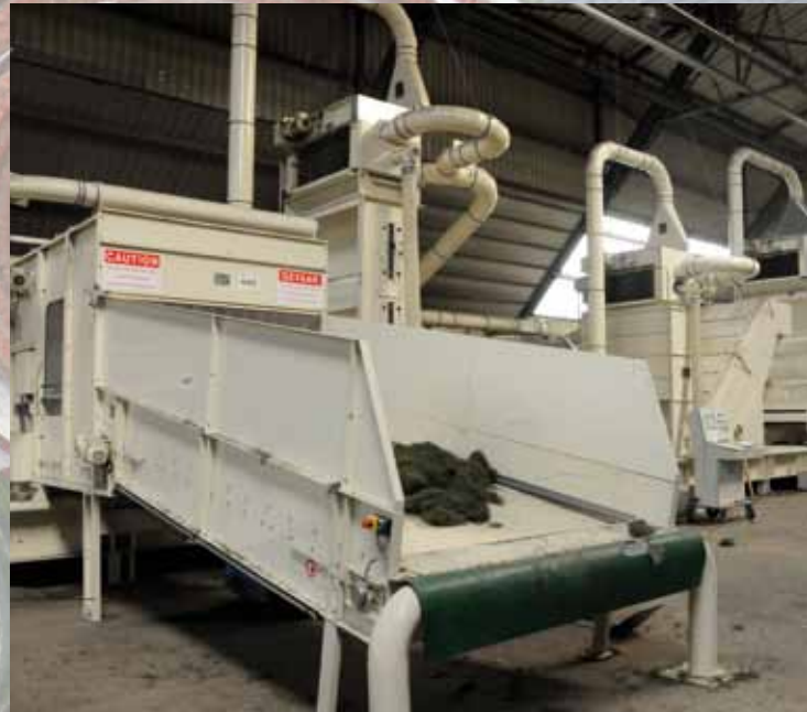
In deze tweede fase wordt de vezel zodanig behandeld dat alle infill-resten en backing verwijderd wordt. Door de batch-gewijze verwerking van de verschillende kunstgrasmaten en wijziging van de machine-instellingen worden er klantspecifieke producten geproduceerd.
