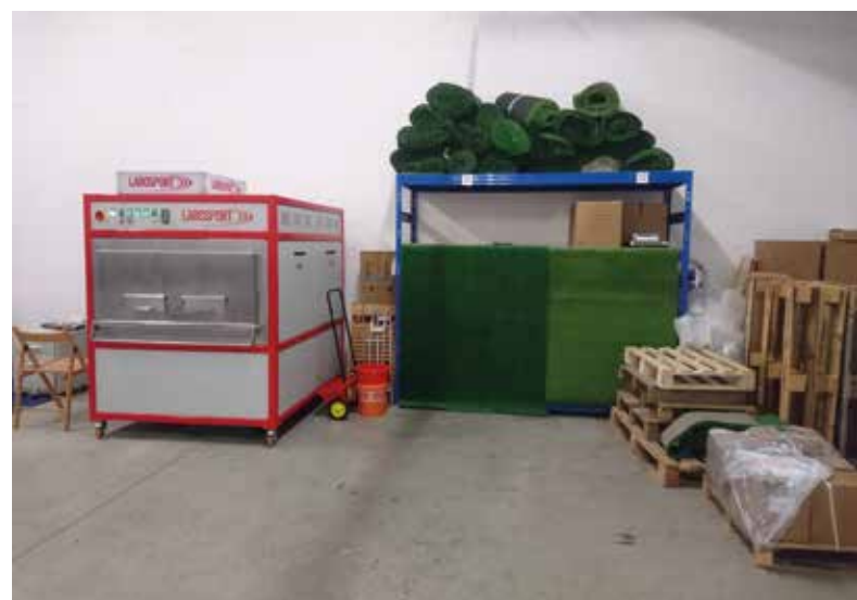
De verfijnde UV tester test hele kunstgrassystemen horizontaal op hun UV stabiliteit.
