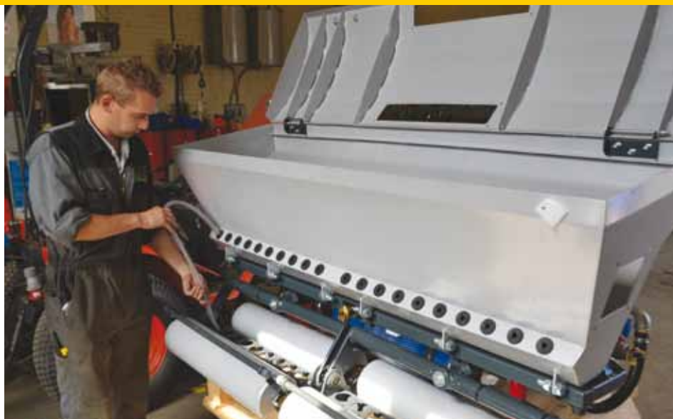
Aanbrengen van de slangen waardoor het water-/zandmengsel onder hoge druk (280 bar) naar de injectors wordt geperst.
