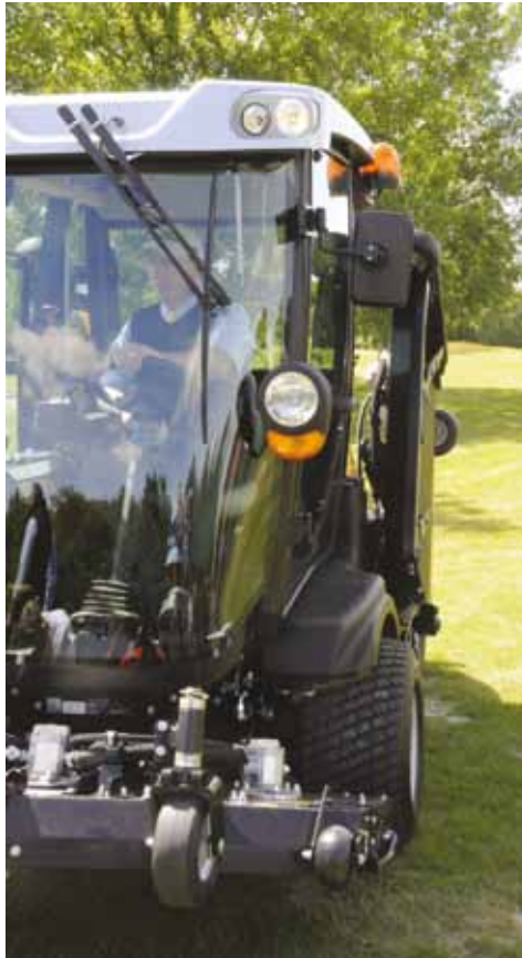
Maaidek klapt weg 'in' de machine, dus geschikt voor smalle doorgangen. Transportbreedte 1,65 meter; volgens Ransomes de smalste in zijn klasse.
