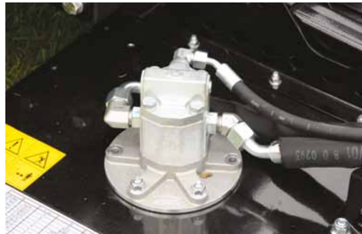
De hydromotoren zijn direct op snijmesses gemonteerd
