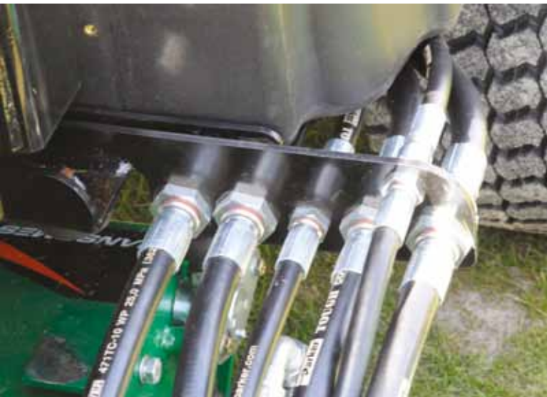
Deze Parker-hydrauliekslangen zijn roteerbaar aan de machinekant.
