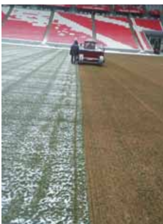
Kazan Arena begin maart: De Overseeder DD1830 zaait het gras in groeven die slechts 3 cms van elkaar liggen, wat korter bij elkaar is dan enig ander type getrokken zaaimachine.
