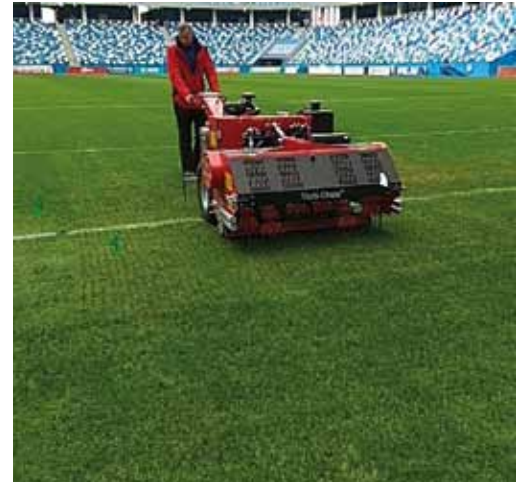
In verschillende stadions werden niet tractoren gebruikt, maar de Redexim Carrier, waaraan dan de onderhoudsmachines werden gekoppeld zoals hier Stadion Nizhny Novgorod met een Verti-Drain model 1513 aangekoppeld. Dit om insporing van de tractor banden tegen te gaan.
