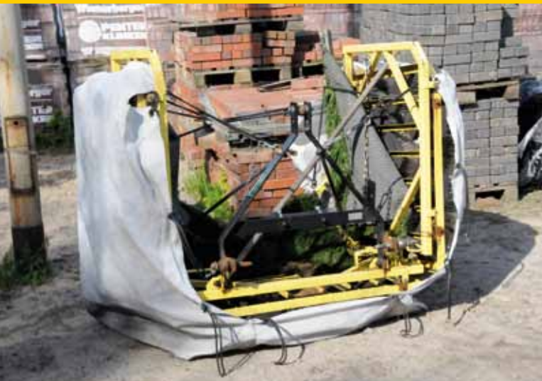
Een eigen vinding: een luier voor de kunstgrasmachine. Infill beland niet op de openbare weg, maar blijft in de luier.
