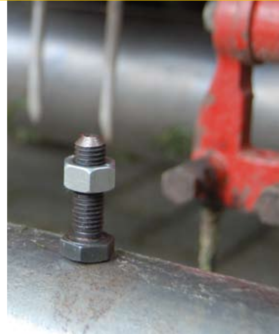
De vertidrain-pennen draai je bij de 7117 vast met bouten en moeren. Voorheen ontwikkelde zich een braampje aan het uiteinde van de platte bouten door het zetten van druk. Dit braampje kon op zijn beurt de moer beschadigen. Redexim loste dit op door bouten met centrische koppen.
