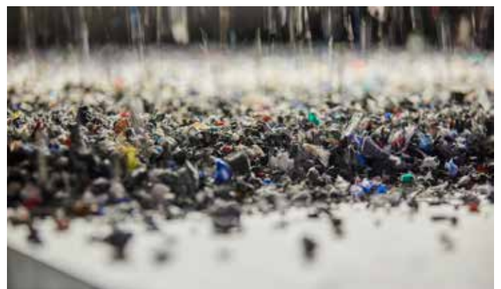
ProPlay shockpads worden gemaakt van hergebruikt foam
