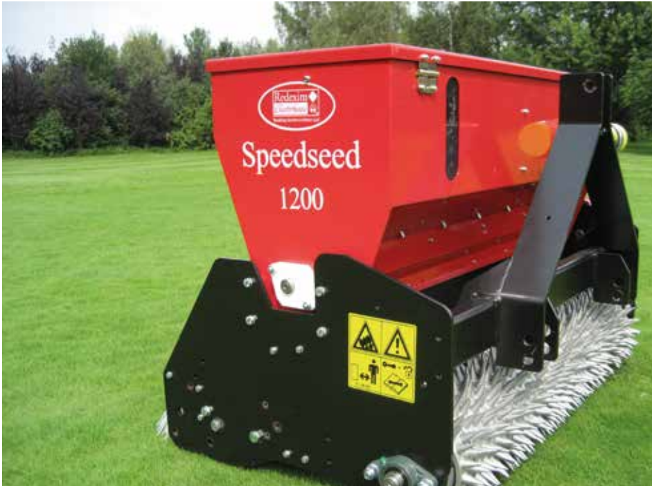
De Speed-Seed verdeelt het zaad in duizenden ondiepe gaatjes (1840 gaatjes per m 2 met de dubbele-roloptie), waardoor een uitstekende grassdichtheid wordt verkregen.
