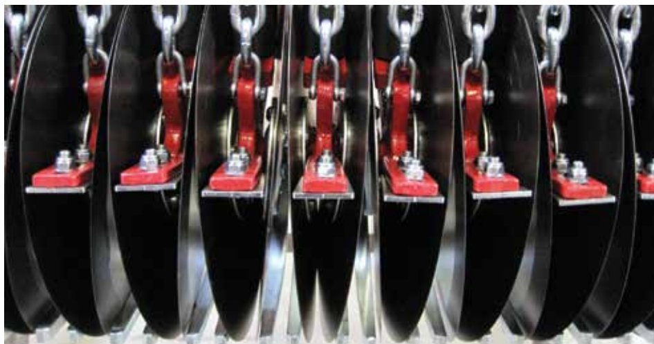
Met de Redexim Overseeder DD-serie (DD= double disc) valt het zaad tussen de schijven door in de groef, die zich daarna sluit. Hierdoor komt bijna al het zaad tot ontkieming.
