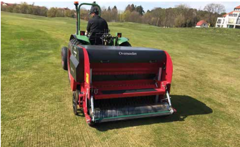
De zaaiafstand tussen de groeven is met de Redexim DD (double disc) Overseeder slechts 3 cm, dichter bij elkaar dan met enig ander type zaaimachine.
