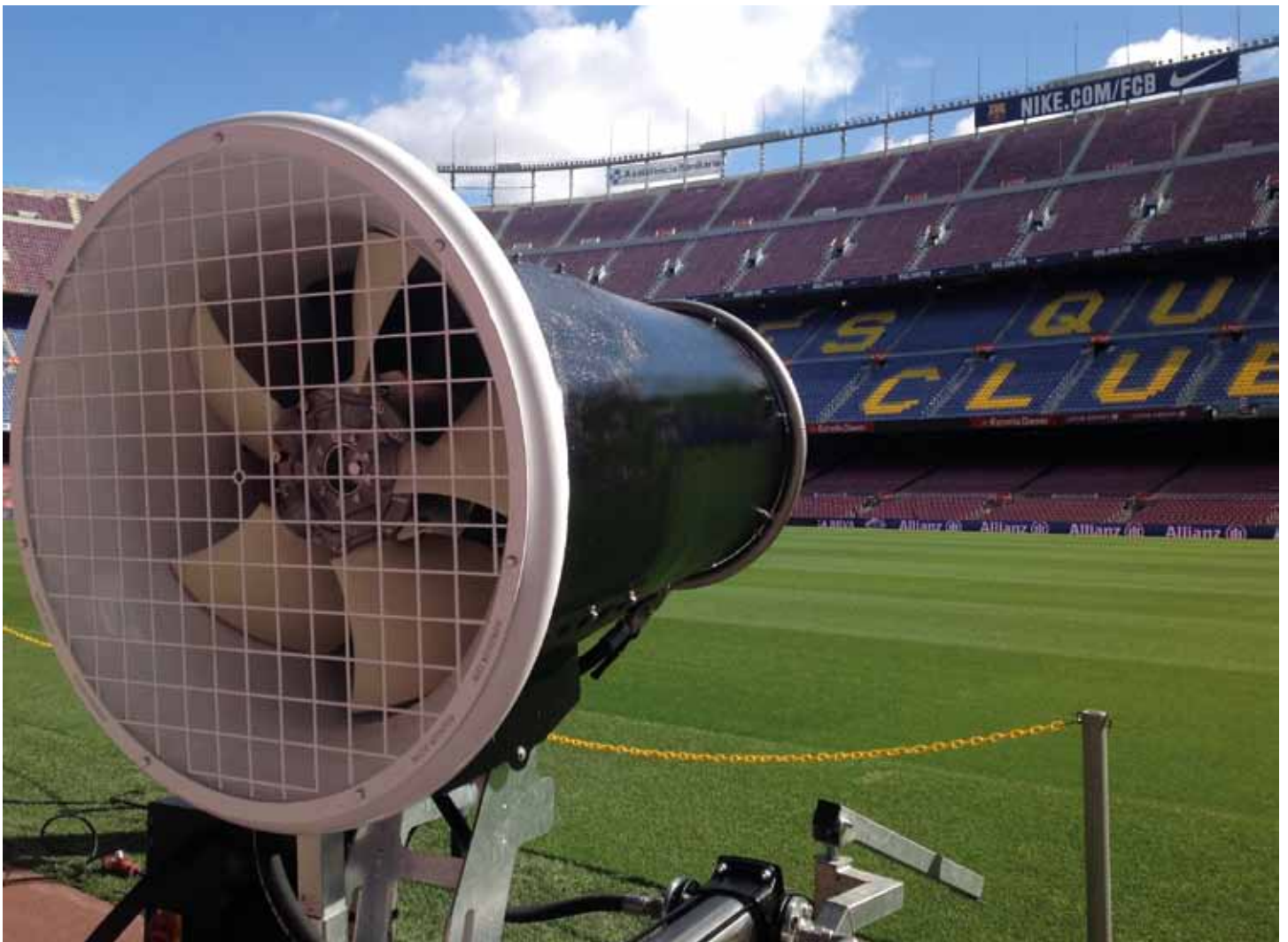
Van 't Klooster: 'Het intervalprogramma verzekert de gebruiker ervan dat de neveldruppeltjes verdampen voordat ze de kans krijgen om de grond te bereiken. Het gras blijft droog.'
