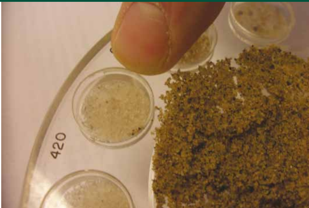
Zandliniaal. Door gedroogd verschalingszand te vergelijken met de verschillende korrelgrootte-verdelingen die in een zandliniaal bijeen zijn gebracht, kiest Kortekaas gericht het gewenste zand voor elk veld om de toplaag te verschralen.
