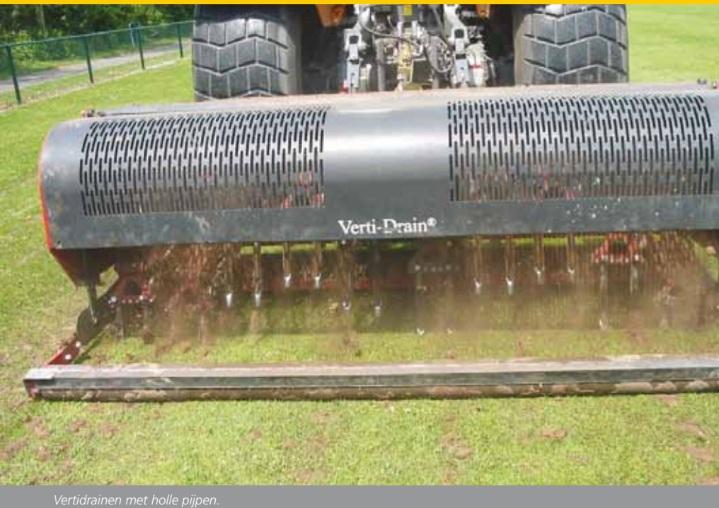
Vertidrainen met holle pijpen.
