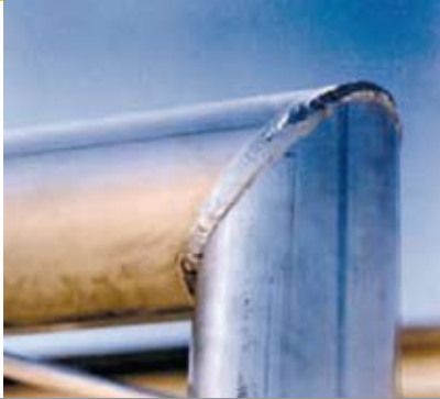
Doelen met gelaste hoekverbinding en inwendige verstevigingen zijn stabiel en gaan langer mee.
