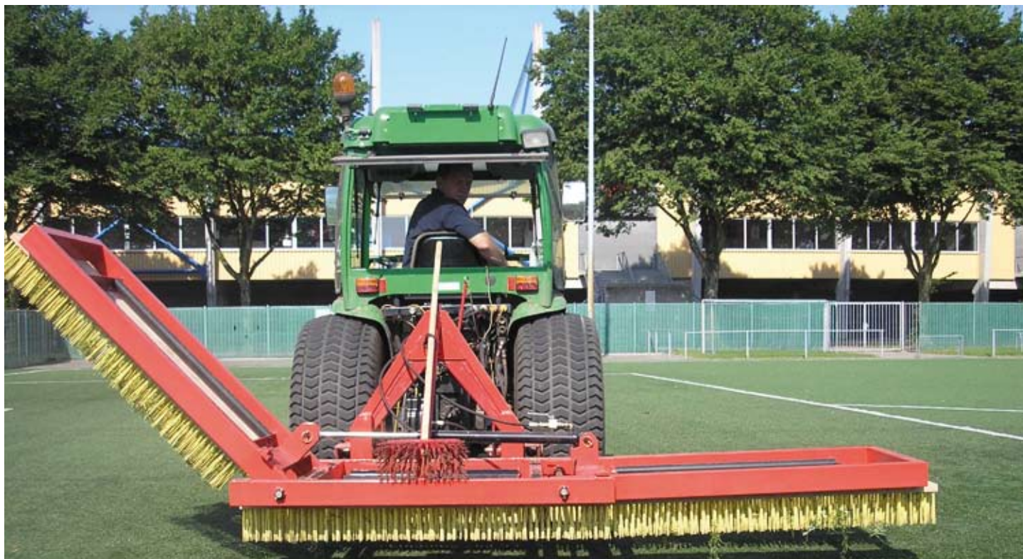
Aanvankelijk waren er ook driehoeksbezems, maar die waren zwaar en onhandig om achter de trekker te monteren en hadden maar een werkbreedte van 1.80 meter. Daarom heeft teamleider Gerard Gillis in de werkplaats zelf een hydraulisch opklapbaar frame ontwikkeld, dat een werkbreedte heeft van maar liefst 4 meter.
