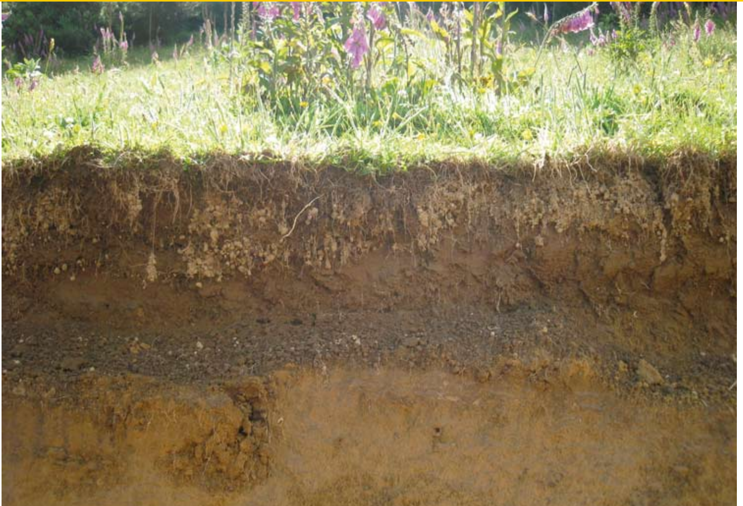
Een ongelaagd bodemprofiel is in het algemeen gunstig voor zowel de aan- en afvoer van water.
