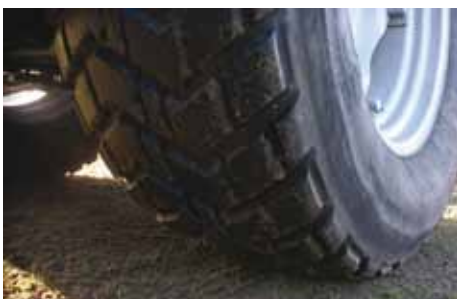
Bodemdruk hoger dan 1 kg per m 2 (= 1 bar) kan de structuur in de diepere lagen verpesten.
