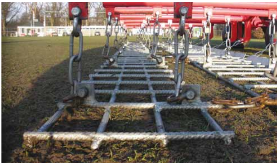
Matten van betonijzer hangen vrij het frame van de competitiesleep.
