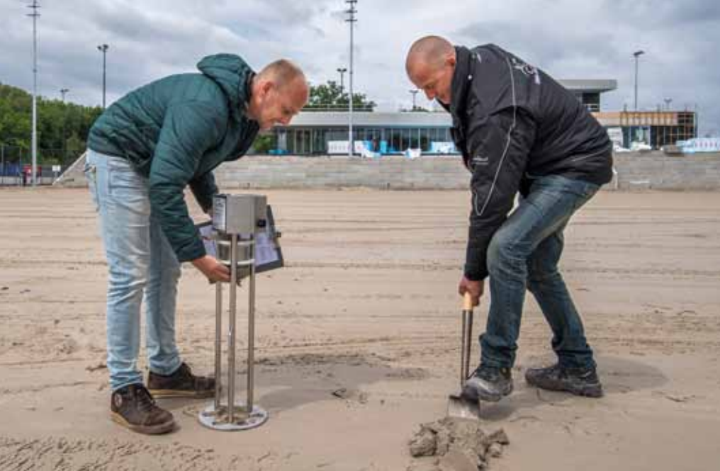
Hans Pennings (r) (CSC Sport) en Patrick de Keijzer (Kiwa Isa) testen dikte en stabiliteit van de zandlaag.
