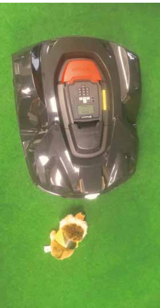
Een proef met een nep-egel maakt duidelijk dat de automower voor dieren geen gevaar oplevert.
